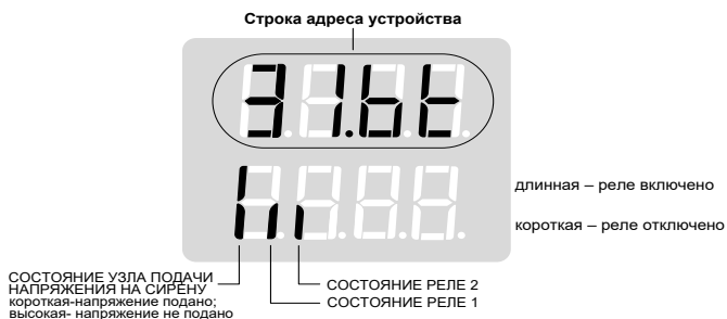
Рисунок 10 – Пример табло показывающего прибора при просмотре состояний реле БПК
