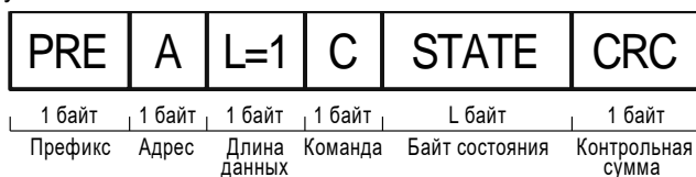
Рисунок 2.4 – Пример пакета байта состояния при отключенном режиме ускоренного обмена
