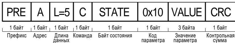
Рисунок 2.5 – Пример пакета байта состояния при включенном режиме ускоренного обмена
